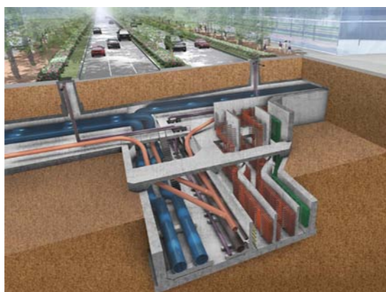
共同溝内に集約された主要ライフライン
