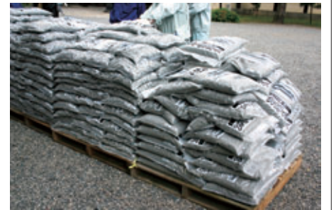
廃瓦と葺土から木材の9倍の調湿効果があるリサイクル品を開発。床下の環境改善のための新素材として再利用。
