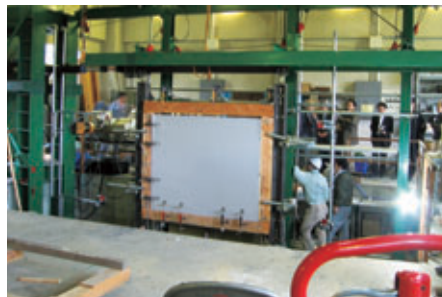
京都大学防災研究所での厚さ24cmの既存土壁強度確認試験。
