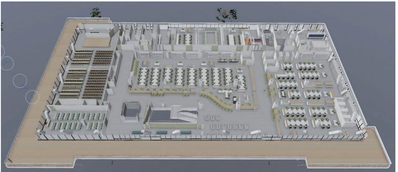
Archicadの設計BIMをベースに維持管理用のBIMモデルを作成、BIMxで検証した
