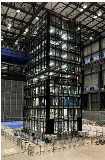
10層鉄骨造オフィス試験体での実証
