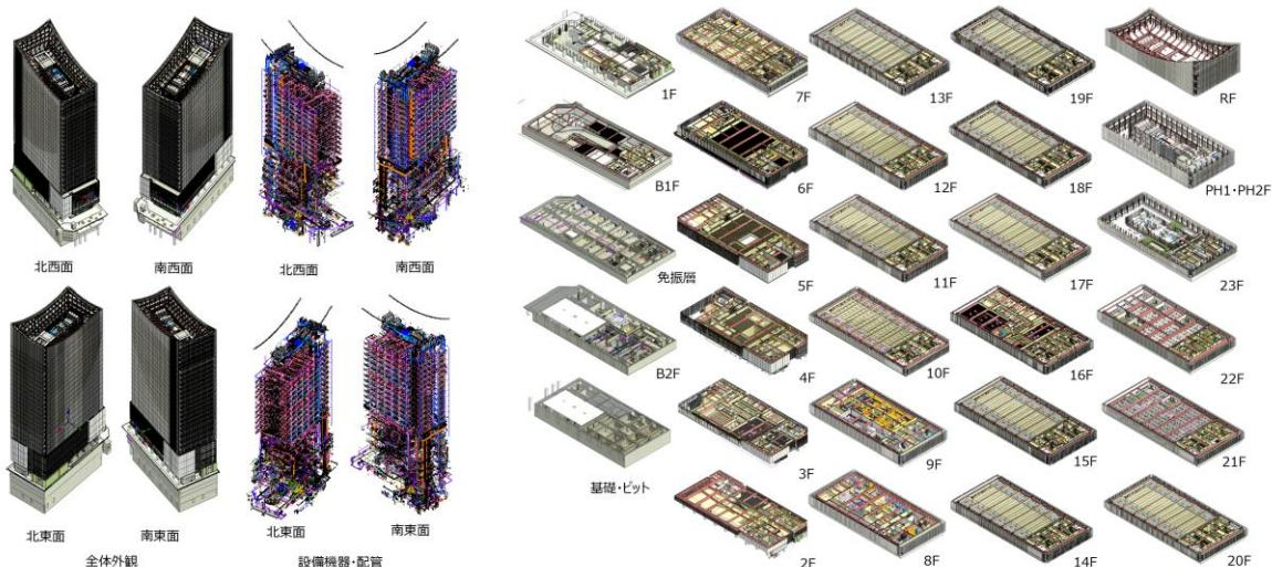
施設内の無数の設備を3Dオブジェクト化した施工用BIMは、あくまで建設・製造のためのBIMで、維持管理には不向きな重く扱いづらいデータになります。維持管理への活用を想定して、モデル化の費用対効果が大きく見込まれるものを優先して選択し、さらに適切なLOD（詳細度）設定により軽量化した維持管理BIMデータを作成することで、管理者がPCブラウザ上で簡単に扱えるようにしました。それは建物オーナー側（コンサルタントを含む）から詳細なEIR（発注者情報要件）を維持管理BIM作成ベンダーに事前に提示することによって実現されました。このように維持管理BIMの作成時にEIRを提示することはまだ前例が少なく、今回その有用性が実証されました。
